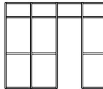
cloison avec porte et 2 traverses horizontales
